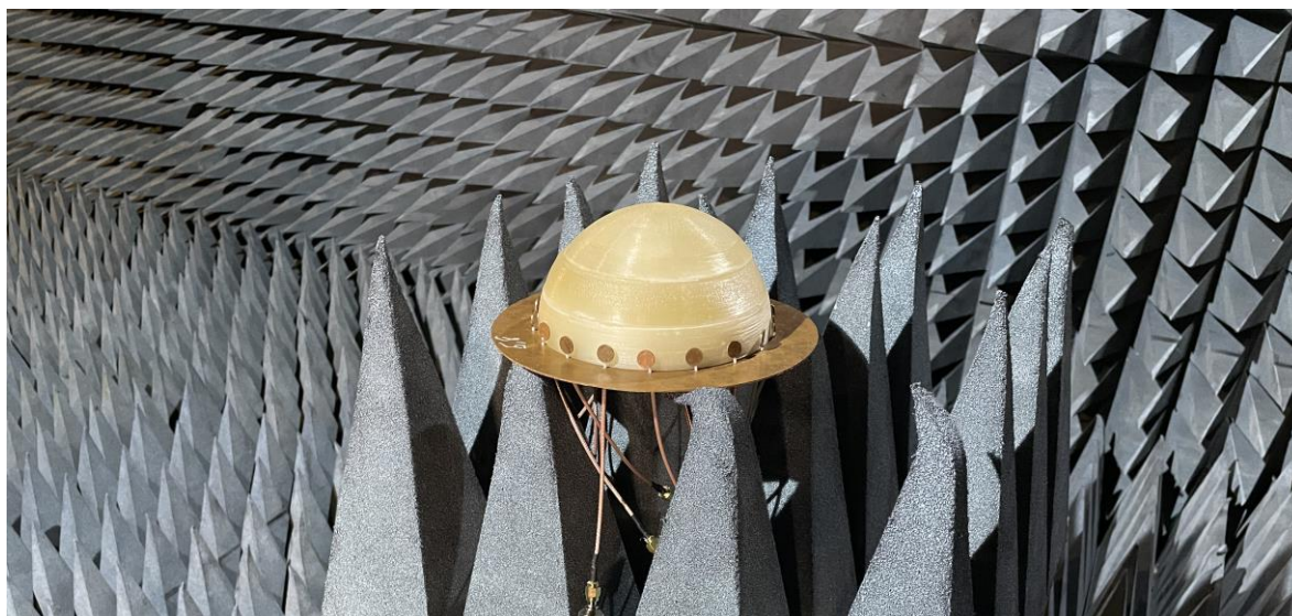
Рис. 6. Фотография макета разработанной многолучевой антенны
